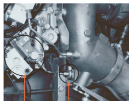
3. Дозуючий модуль 2. Помпа Магістраль 1. Бак з сечовиною 4. Форсунка AdBlue (розташована в області двигуна)
